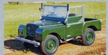
Serie I Ganz zu Anfang sitzen die Scheinwerfer noch hinter dem Kühlergrill
