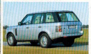
Früher Zweitürer von 1975. Geglätteter Range Rover II 1994 bis 2002. Range Rover III (BMW-Regie) ab 2002 mit Einzelradaufhängung und selbsttragender Karosserie
