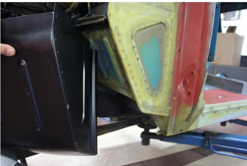
Auf diesem Bild seht Ihr den von uns restaurierten Fußkasten eines Range Rovers und davor den günstig erhältlichen Reparaturfußkasten. Seht Ihr die Unterschiede? Diesem Fußkasten fehlt die untere und vordere Kante. Diese ist wichtig um den äußeren Kotflügel zu befestigen und trägt zur Stabilität bei!
