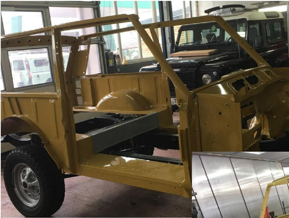
Hier Bilder einer aktuellen Restauration. In diesem Project wurden praktisch alle Einzelteile der Karosserie entweder verzinkt oder KTL beschichtet bevor sie lackiert und dann zusammengebaut wurden.
