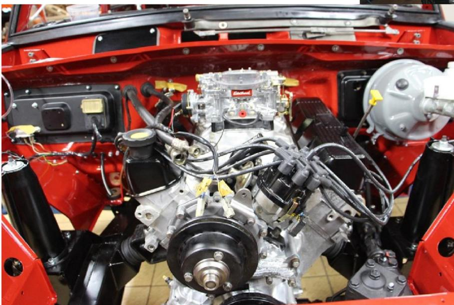
Hier z. B. wird gerade ein auf 5,4 Liter erweiterter originaler Rover Motor eingebaut welcher den Wagen in Verbindung mit verbessertem Fahrwerk etc. Auch heute noch zu einem sehr schnellen Range Rover macht
