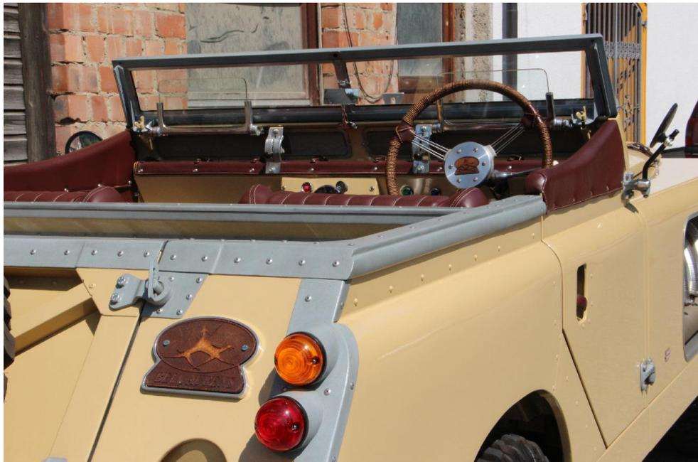
so dass ein echter Zweisitzer ohne Aufbau, Windschutzscheibe oder Türen entsteht. Fahrer und Beifahrer sitzen fast auf der rumpelnden Hinterachse. Die Gesamtlänge bleibt mit 4,50 Metern unverändert. Durch fehlenden Aufbauten und Komfortdetails reduziert sich das Gewicht auf spartanische 1,2 Tonnen.
