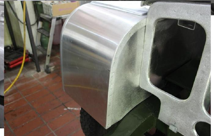
Ebenso musste der Abschluss vom Sitzkasten in Richtung Getriebetunnel und Bodenblech gebaut werden.
