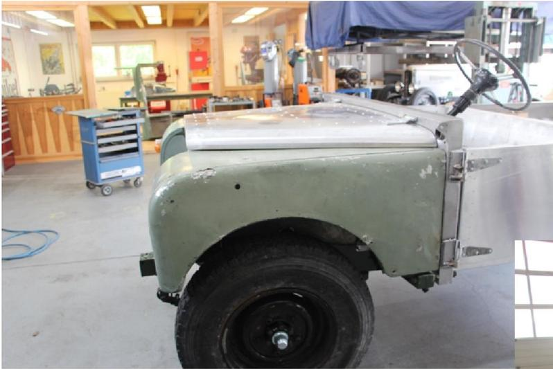
Beim Karosseriebauer mussten noch Kotflügel und Getriebetunnel gefertigt werden sowie die ganze Karosserie ausgerichtet werden. Dazu wurden zunächst die alten Kotflügel montiert um Maß zu nehmen.
