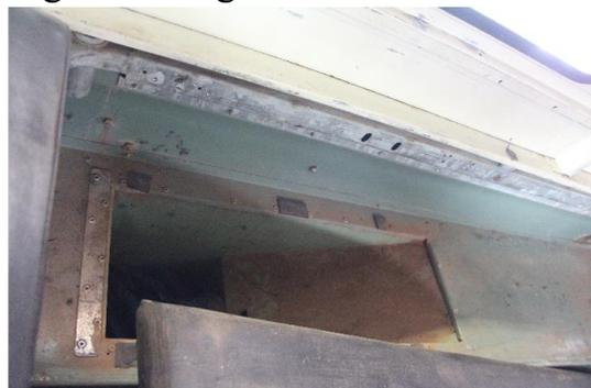
Kratzer und eine gröbere langgezogene Welle in der rechten Seitenwand. Hinten sind rechts und links zwei Flacheisen für irgendwelche Zusatzbefestigungen festgeschraubt. Im Innenbereich sind rechts und links hinten in den
