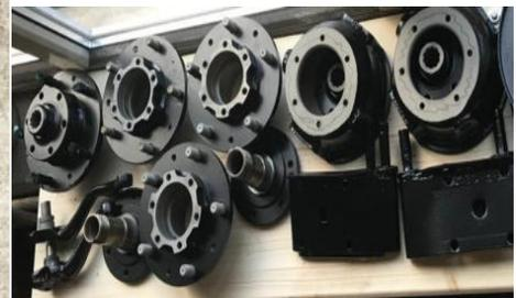
Wir konnten durch das Verfahren, thermische Entlackung, Glasperlenstrahlen und Beschichten, die Qualität bei der Überholung der Achsrohre und der Swivel Housings nochmals verbessern. Anbei einige Bilder.
