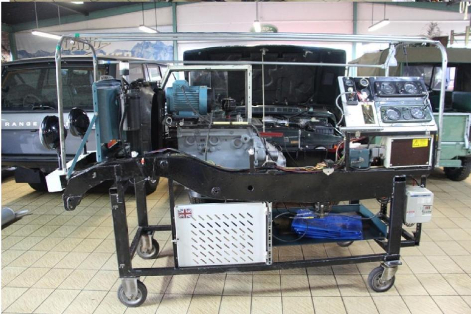
Dieses Gerät ermöglicht uns Landymotoren probelaufen zu lassen, oder wahlweise Getriebe stundenlang zu testen,
