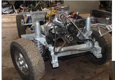
Vor zwei Jahren wurde alles von Grund auf restauriert und mit neuteilen oder überholten Teilen aufgebaut. Wo es ging wurden Heavy Duty Teile verwendet. Was möglich war wurde verbessert. Selbstverständlich mit neuem verzinkten Rahmen und neuer Spritzwand, Türen etc.
