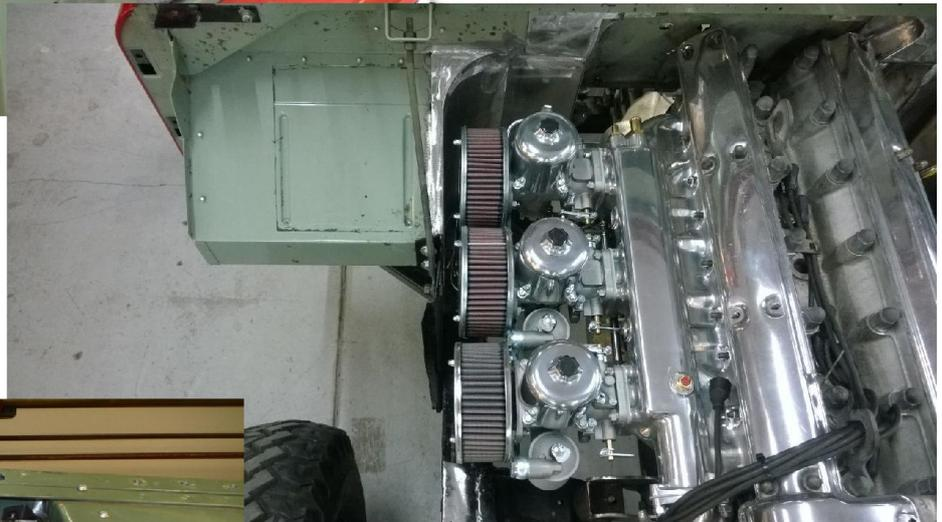
Wie hier ein Umbau/Restauration eines SIIa 109er auf einen Jaguar XK Motor mit 3 fach SU Vergaseranlage, und Servolenkung und raffiniert ausgeklügelter unsichtbar eingebauter Klimaanlage/ Standheizungskombination im Sitzkasten
