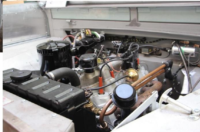
links im Bild ein falscher Vergaser, der originale wird gerade restauriert. Siehe unten.
