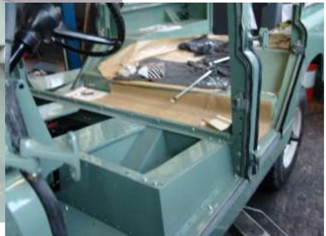
Auch bei der Restaurierung der Innenausstattung wurde enormer Aufwand betrieben, selbst die originalen Sitze wurden zerlegt, die Federkerne entrostet und verzinkt! Anschließend mit Leder neu gesattelt. Um einen originalen Dormobile Innenhimmel zu bauen wurde eigens eine Positivform
