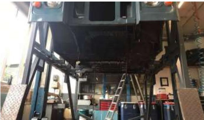
Hier werden gerade neue Bremsleitungen von Fabi und Alex auf das neue Chassis montiert.
