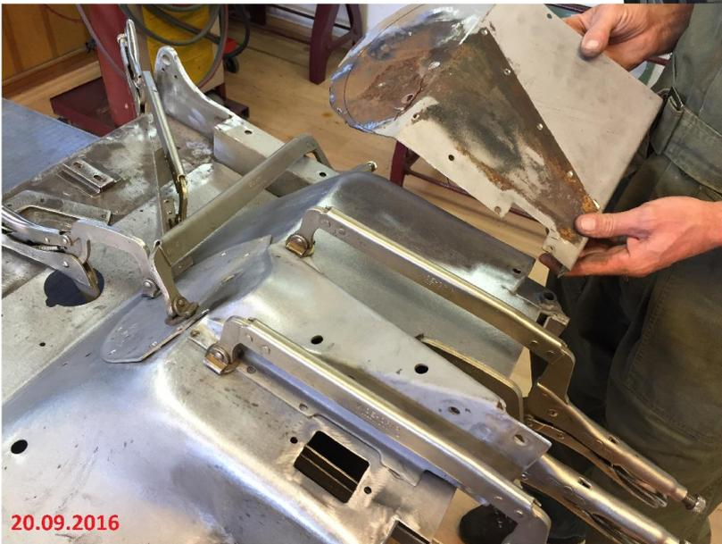
Die originale Spritzwand wird perfect überholt, dazu werden alle aufgepunkteten Bleche abgetrennt um den dazwischen liegen Rost zu entfernen und ggf. auch dort zu schweißen
