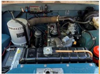
Das Originalfahrgestell wurde entlackt, sandgestrahlt und verzinkt. Servolenkung und vordere Scheibenbremsen von einem späteren Santana-Modell eingebaut. Vollsynchronisiertes, überholtes 4-Gang-Getriebe der Serie III mit Overdrive eingebaut. Der Motor wurde überholt, und auf Bleifreibetrieb umgerüstet. Neuer drehmomentstarker Anlasser. Neuer Kabelbaum,
