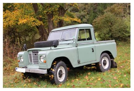
(für Neulinge: jeder 88er Landy kann zum offenen Landy umgebaut werden, Pick-up Dachschale, oder Festes Dach sind immer nur geschraubt und modular wechselbar!)
