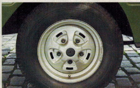
Auf großem Fuß: Stahlrad im „Rostyle“-Look, originalgetreu umkränzt vom Michelin-X-Pneu der Dimension 205 x 16 M+S
