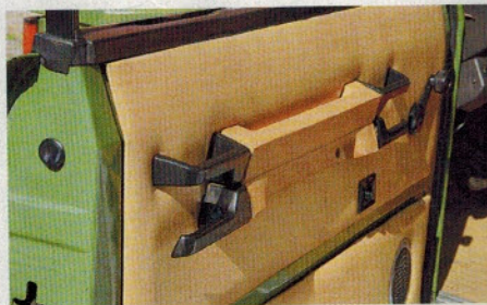
Notausstieg: Mittels zusätzlicher Zugbügel sind die Türen auch von der Rückbank aus zu öffnen. Unschön: das Material der Türtafeln
