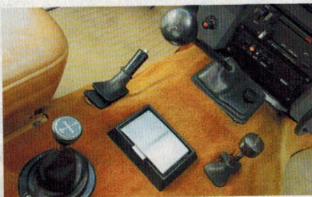
Schalten und falten: Fünf Hebel lugen aus vier Gummibälgen heraus. Der Overdrive (unten links) wurde erst 1980 nachgerüstet
